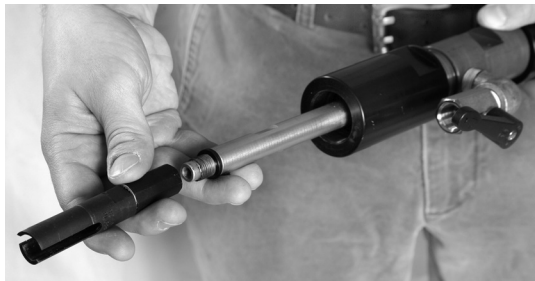
Fixez l'écrou d'accouplement à l'emporte-pièce.
